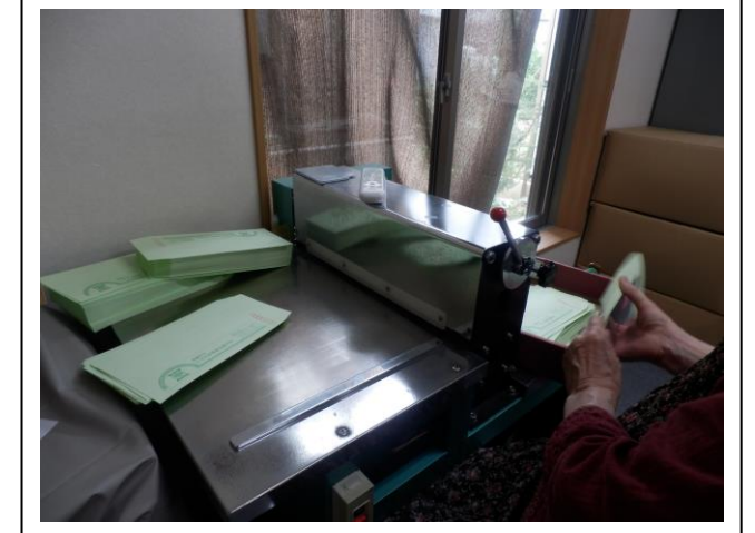
PM-10 型点字印刷機
